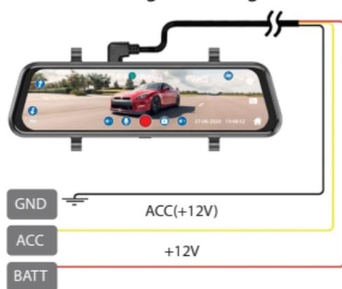
Кабель питания **iBOX 24H Parking monitoring cord S10** позволяет не допустить критической разрядки аккумулятора автомобиля. В каком бы режиме ни работал видеореги­стратор, кабель автоматически отключает его питание, при падении напряжения ниже 11,8 В для аккумуляторов с напряжением 12 В и ниже 23,4 В для аккумуляторов с напряжением 24 В.
